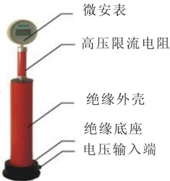
图2 倍压筒示意图
