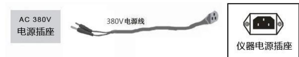
图 3 测试仪 AC380V 电源供电接线图
