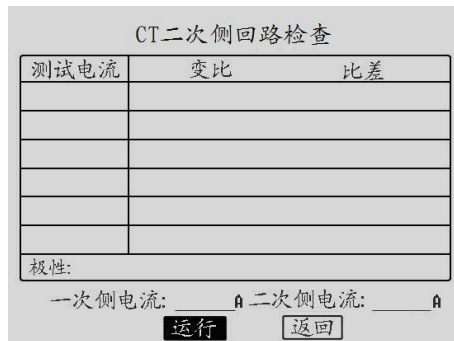
图 31 CT 二次回路检查测试界面
