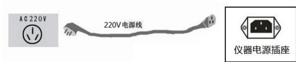
图 2 测试仪 AC220V 电源供电接线图
