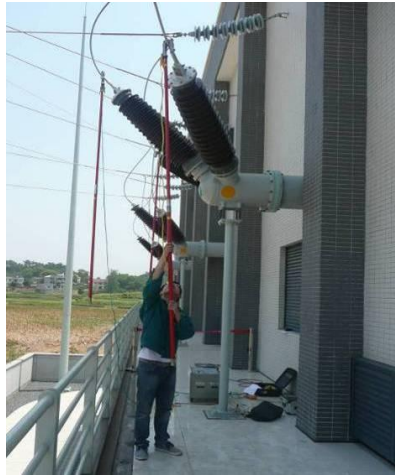
图 6-2：测试线通过绝缘棒引到被测线路
